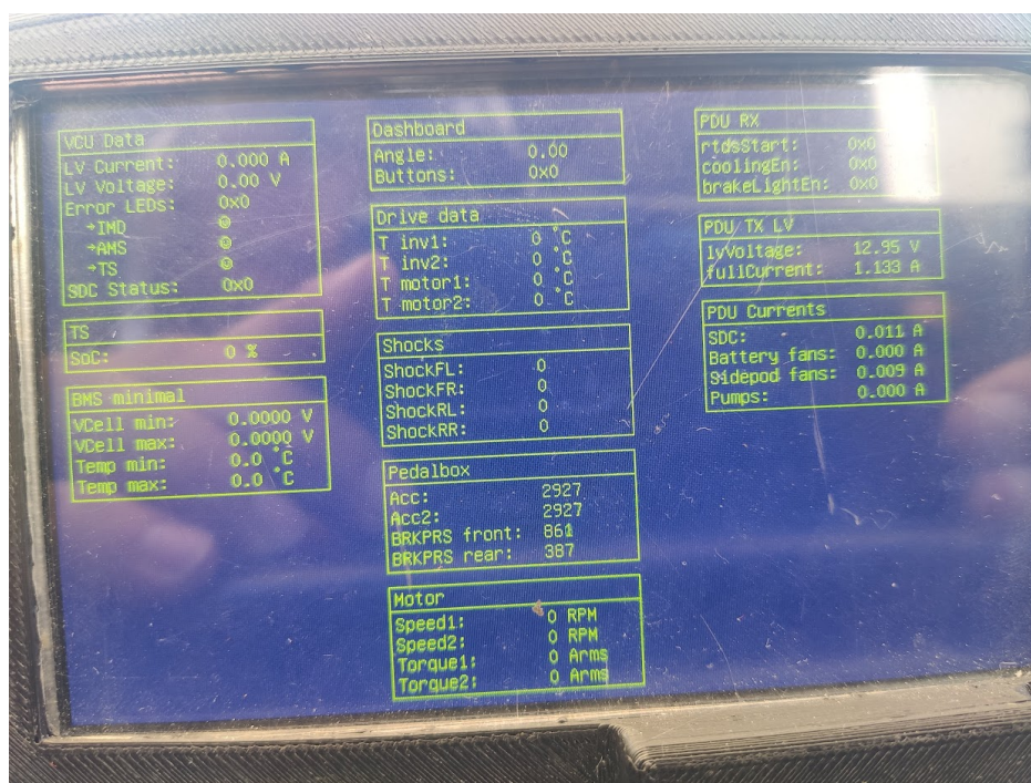
Slika 6.3: Zaslón za razhroščevanje. Nekatere naprave v času zajema posnetka še niso bile priklopljene na vodilo.
