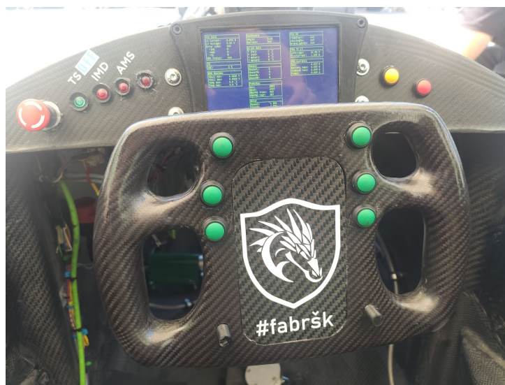
Slika 5.1: Armaturna plošča in volan dirkalnika z vgrajeno strojno opremo
